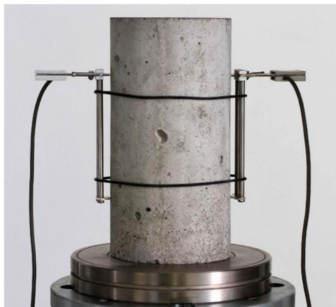
Figura 8 – Clip gage instalado em um corpo de prova de concreto.
